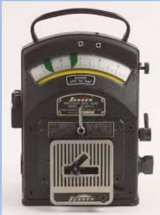
Le **SUNNEN PG-800E Précision Bore Gage** est pour les diamètres de 0,370 à 1.500 po (9,4 mm à 38,1 mm). Échelle de lecture directe avec 0,005 po (0,13 mm) de gamme divisée en incrément de 0,00005 po (0,001 mm).
